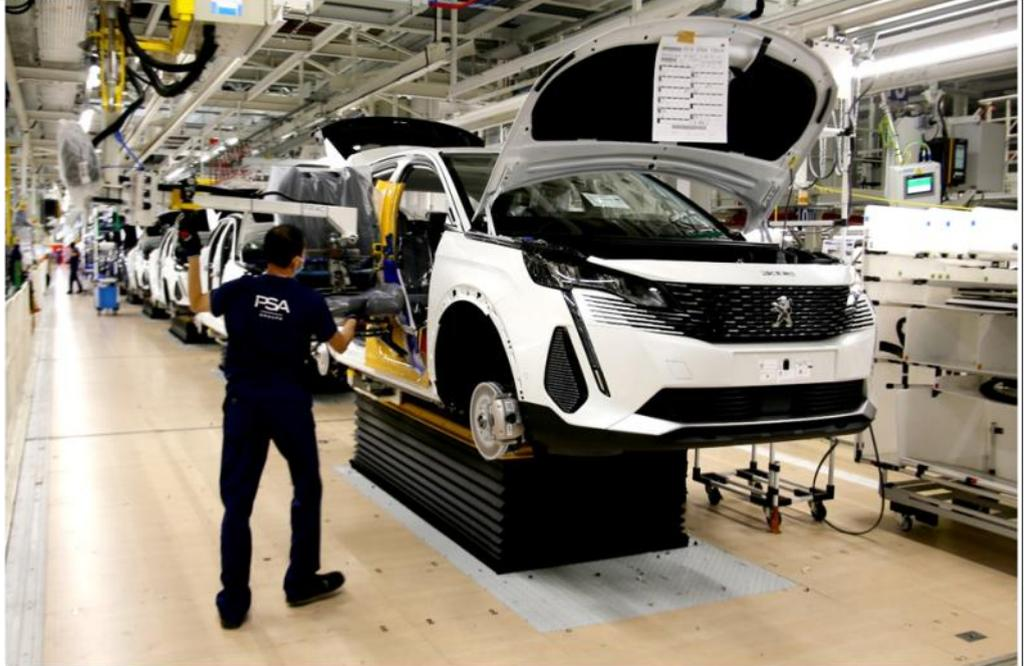
permettent d'ajuster la hauteur de travail en fonction des opérations à effectuer, un atout indéniable en matière d'ergonomie.
