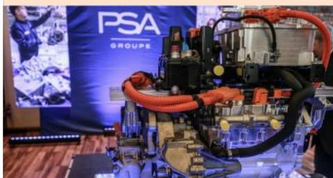
Le moteur à propulsion électrique, c'est cette grosse bête. Un volume difficilement comparable aux moteurs thermiques pourtant bien plus complexes. Car, au moteur proprement dit, s'ajoutent les composants majeurs : mini boîte de vitesses, chargeur de batterie, toute la partie électronique, compresseur de climatisation, etc. Pascal BROCARD
