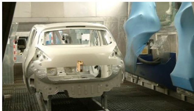
Les nouvelles cabines peinture équipées de robots avec pulvérisateurs à réservoirs.
